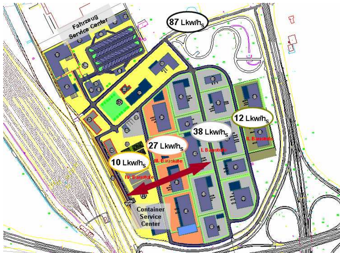
Abb. 11 Lkw-Verkehrsaufkommen in der Spitzenstunde für die jeweilige Baustufe
